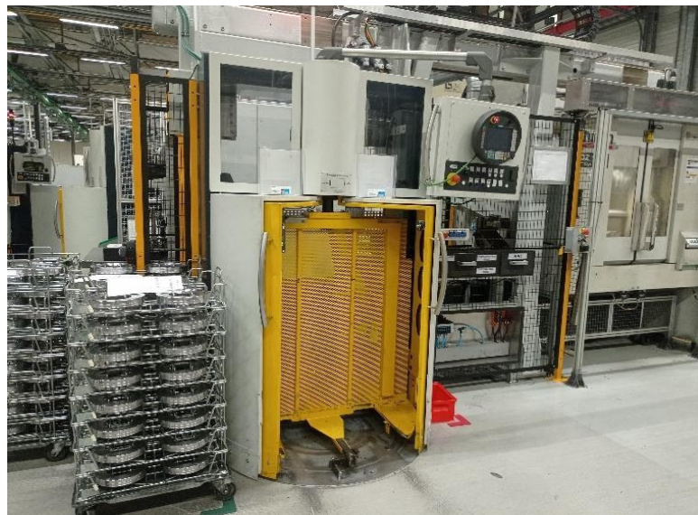
Figura 22: Cella del Felsomat per l'immissione e contemporanea fuoriuscita dei componenti da lavorare/lavorati
